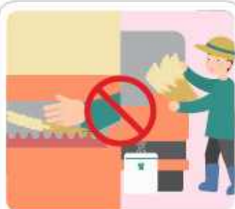
손담곡을 할 때에는 손이나 작업복 등이 말려들어가지 않도록 주의하고, 한꺼번에 많은 벼를 투입하지 않습니다.
